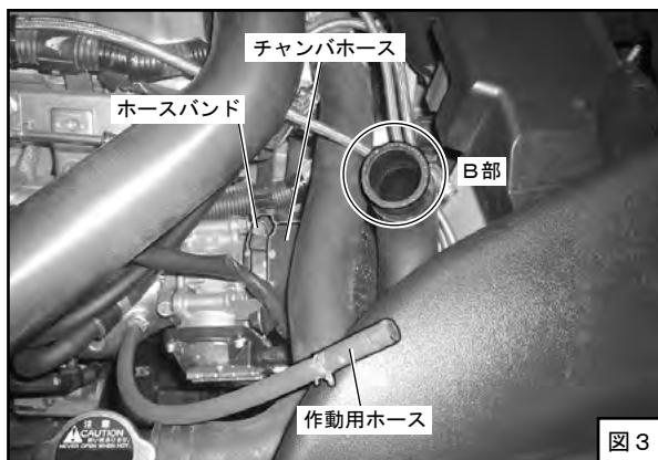
(2) チャンバホースのホースバンドをゆるめ、ブローオフステーを仮付けしてください。 (図 3、図 4、図 5)
