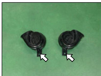
取付け穴を 8~8.5mm に拡大する。
