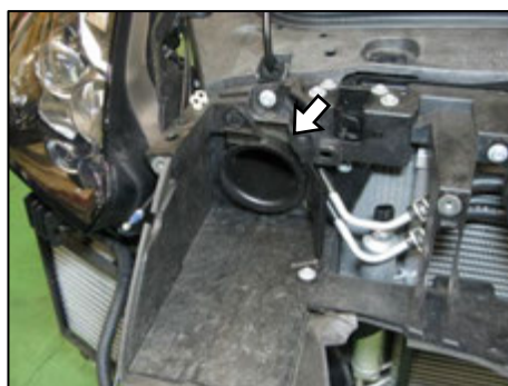
エアファンネルを取外す(左右)
