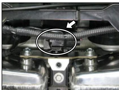
純正の温度センサーはハーネスにタイラップで固定する。
