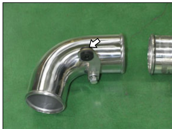
純正 I/C のグロメットを外し、ブラケットに取付ける。
