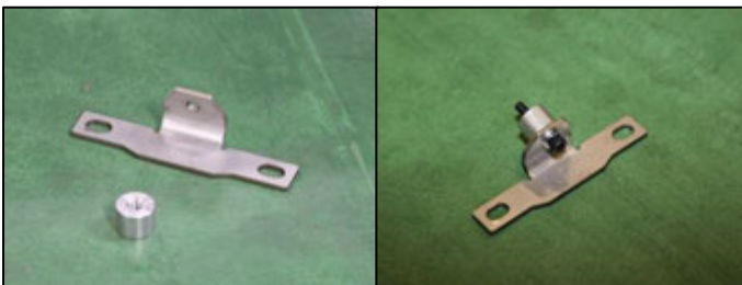
P4: インタークーラブラケット No.1 P17: スパースー P26: M6 六角穴付きボルト L=35 P27: M6 スプリングワッシャ P28: M6 プレートワッシャ
