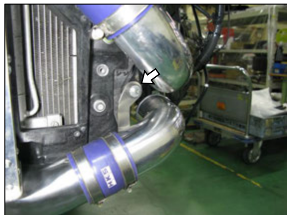
純正ボルトを使用し、取付ける。
