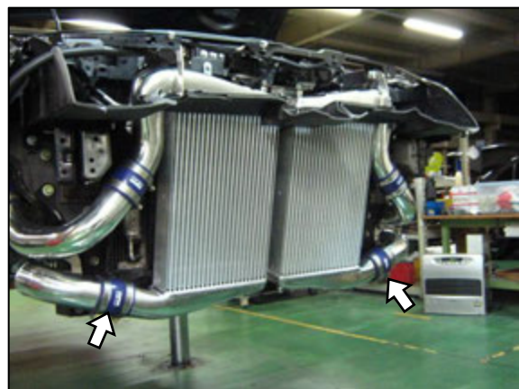
シリコンホース、ホースバンド取付け箇所。
