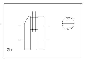
2.6 VR38 4.3L KIT のクランクは、ピン両側のスミ R を 純正品の寸法より拡大していますので、ベアリングとの 干渉を避けるため、使用するベアリングを下図の寸法に 加工して下さい。
