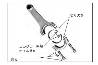
3.3 コンロッドのベアリング内面にエンジンオイルを 塗布し、図 6 の様にコンロッドを傾けオイル ジェット及びシリンダ内壁に当たらないように挿入 してください。
