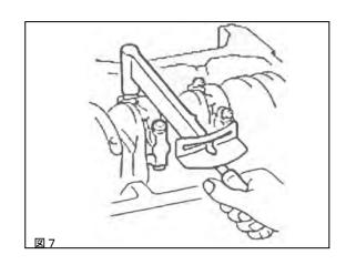
(4) コンロッドボルト締付け後、クランクシャフトがスムーズに回転することを確認してください。
