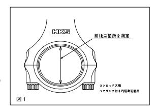
2.2 図1のようにベアリングを入れた大端内径の上下方向を シリンダゲージ等で前後2ヶ所測定してください。 (オイルクリアランスの計算には、小さい方の値を 使用します。)
