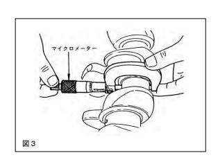
2.5 2.1、2.2で測定したベアリング内径と、2.4 または2.5 で確認したクランクピン径よりオイルクリアランスを計算します。
