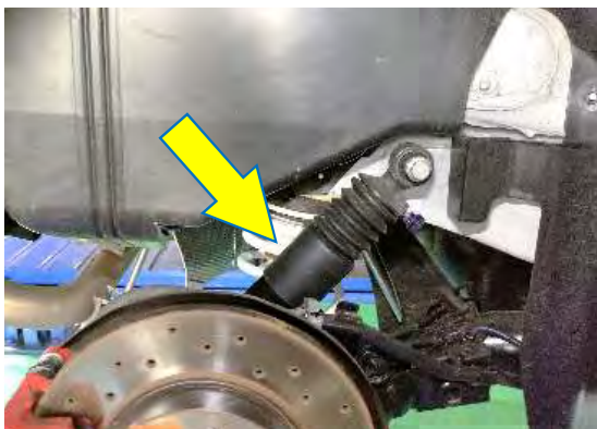
■ リフトダウンした(1G)状態 ダストブーツがシリンダに被さっている (走行開始前に写真のような状態に なっていることをご確認ください)
