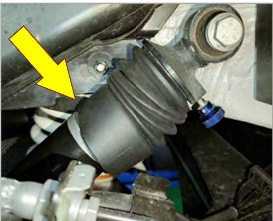
■ リフトダウンした(1G)状態 ダストブーツがシリンダに被さっていない ため ストローク時にジャバラ部が押しつぶされる
