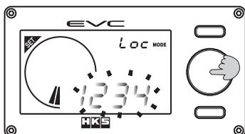
(2)ボリュームを回して、ロックナンバーを設定してください。設定が終了したらボリュームを押して決定します。
