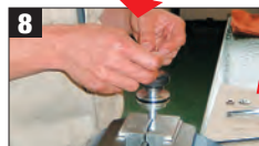
消耗した各部品は交換した上で洗浄した部品とともに組付けていく。
