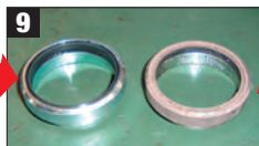
ダストシール等のゴムシート類は経年変化で劣化するので交換する。 右が装着されていたもの、左が新品。
