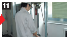
組立て終わったら減衰力試験機にてテストを行ないチェックする。
