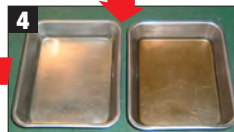
右:ダンパーの中に入っていたオイル、熱等により劣化し変色 左:新品のオイル。サラダ油のような色
