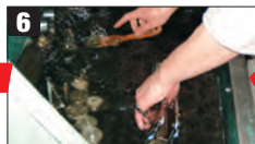
分解した部品を洗浄ブースで洗う。
