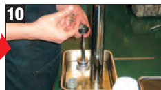
エアが入らないよう部品のすきまにオイルを注入しながら組付ける。
