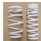
スプリングは、不等ピッチ及び樽型形状を採用。有効ストローク量を確保しながらローダウン時にも遊びが発生しにくい形状です。また、いたづらにレートが上がらず、純正ショックアブソーバーとのマッチングを考慮した特性となっています。
