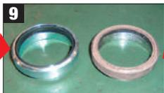
9 ダストシール等のゴムシート類は経年変化で劣化するので交換する。右が装着されていたもの、左が新品。
