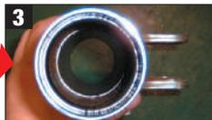
3 倒立式の場合、アウトケース(外筒)内部も調べ、サビ・汚れが見られる場合は洗浄する。
