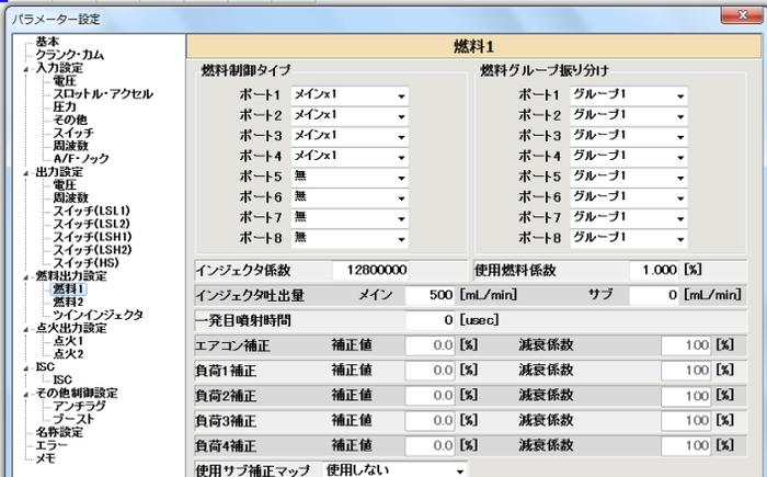
■ポート1～8設定 = 上記設定では「メイン×1」の入力が4ポート行なわれております。4気筒シーケンシャル噴射の設定状態となります。1サイクル = 720度中1回だけ噴射しなさいという状態となります。尚、「メイン×2」の設定で同時噴射の状態 = 1サイクル・720度中2回噴射しなさいとなります。ですので「サブ×1・2」「独立×1・2」においてもツインインジェクタモードに依存するか独立噴射時間MAPに依存するかの違いで、基本的には1サイクル中に何回の噴射指令を行うかの設定となります。
