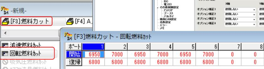
触媒装着車両に於いては上記のカット条件の設定にて「回転数」に☑をつけて下さい。その後、回転燃料マップにて各ポートの燃料カット回転数の決定を行います。上記設定では各ポート毎に6950rpm・7000rpmにて回転数に50rpmの差を設けてあり、最高回転数に到達した場合に、急に燃料カットが入るのを防止しております。上記設定はドライブフィーリング向上のための一手段として提案させていただきます
