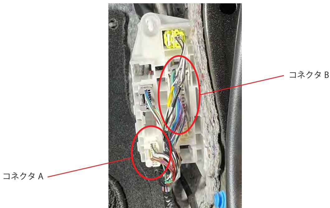
⑤コネクタ A の車速信号線を切断し、SLD Type I の車速信号入力線と車速信号出力線をギボシを取付け、SLD と接続してください。
