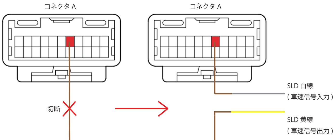
⑥コネクタ B の電源線を切断し、ギボシを取付け SLD と接続してください。
