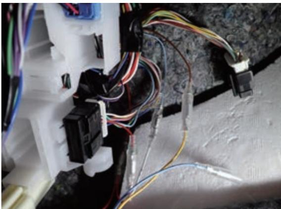
⑦ 下記コネクタ B の電源線 (B-1) にギボシを取付、SLD の電源線 (赤) へ接続してください。
