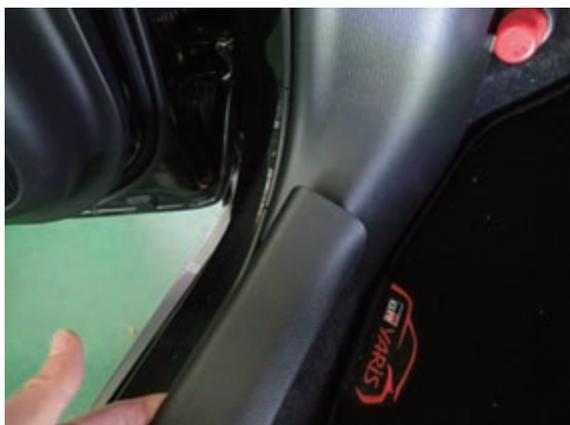
③ プラスチックのネジを外し、足元左側のカバーを外します。
