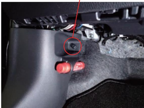
④ SLDの車速信号線を配線するコネクタ（コネクタ A）を、作業できる位置まで引き出します。
