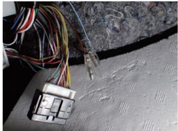
⑥ 上記 A-1 を SLD の車速信号出力線 (黄) へ、A-2 を SLD の車速信号入力線 (白) へ接続してください。
