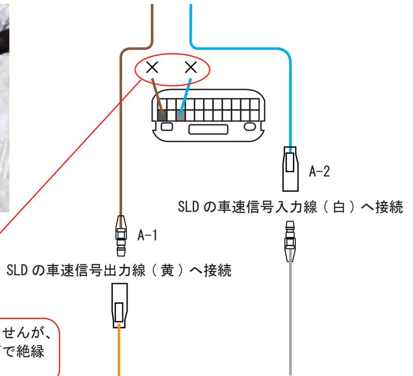
コネクタに残った電線に電流は流れていませんが、他への接触を防ぐためビニールテープなどで絶縁処理してください。
