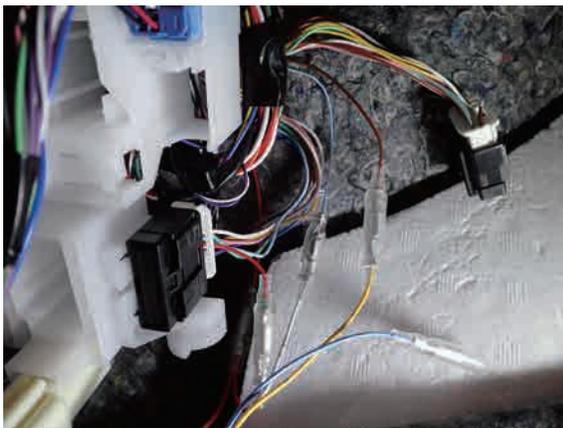
⑦ 下記コネクタ B の電源線 (B-1) にギボシを取付、SLD の電源線 (赤) へ接続してください。
