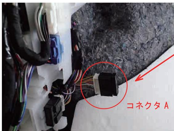
⑤ コネクタ A の車速信号線 (A-1、A-2) を切断し、ギボシを取り付けます。
