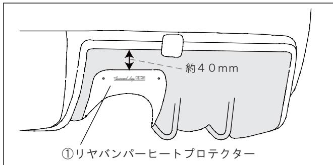
(1) 予め、メインマフラーを取り外し、①リヤバンパーヒートプロテクターをリヤバンパーのマフラー切りかき部分にあてがい、合い添いを微調整し、取付け位置を確認して下さい。
