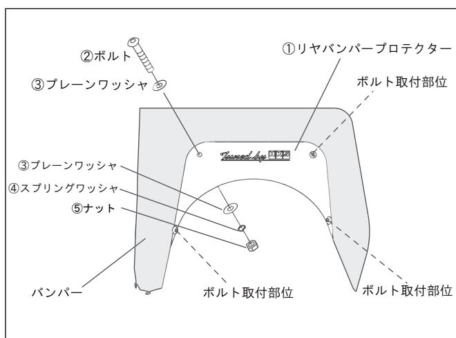
(2) ①リヤバンパーヒートプロテクターを取り外し、ポンチ痕にドリルの刃をあて、 $\phi 4.0\text{ mm}$ の穴あけ加工を行います。
