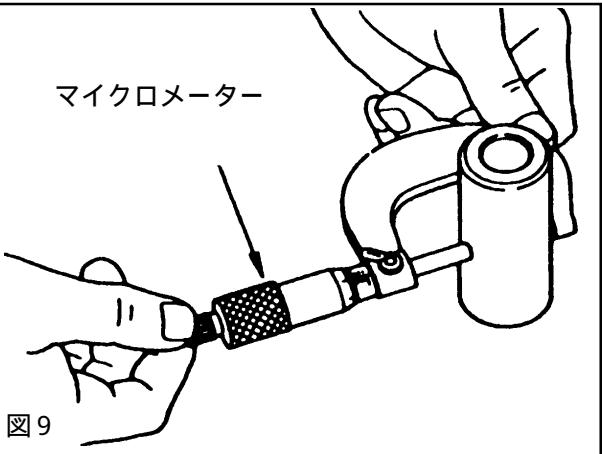
(コンロッド小端部オイルクリアランス) = (コンロッド小端部内径) - (ピストンピン外径)
