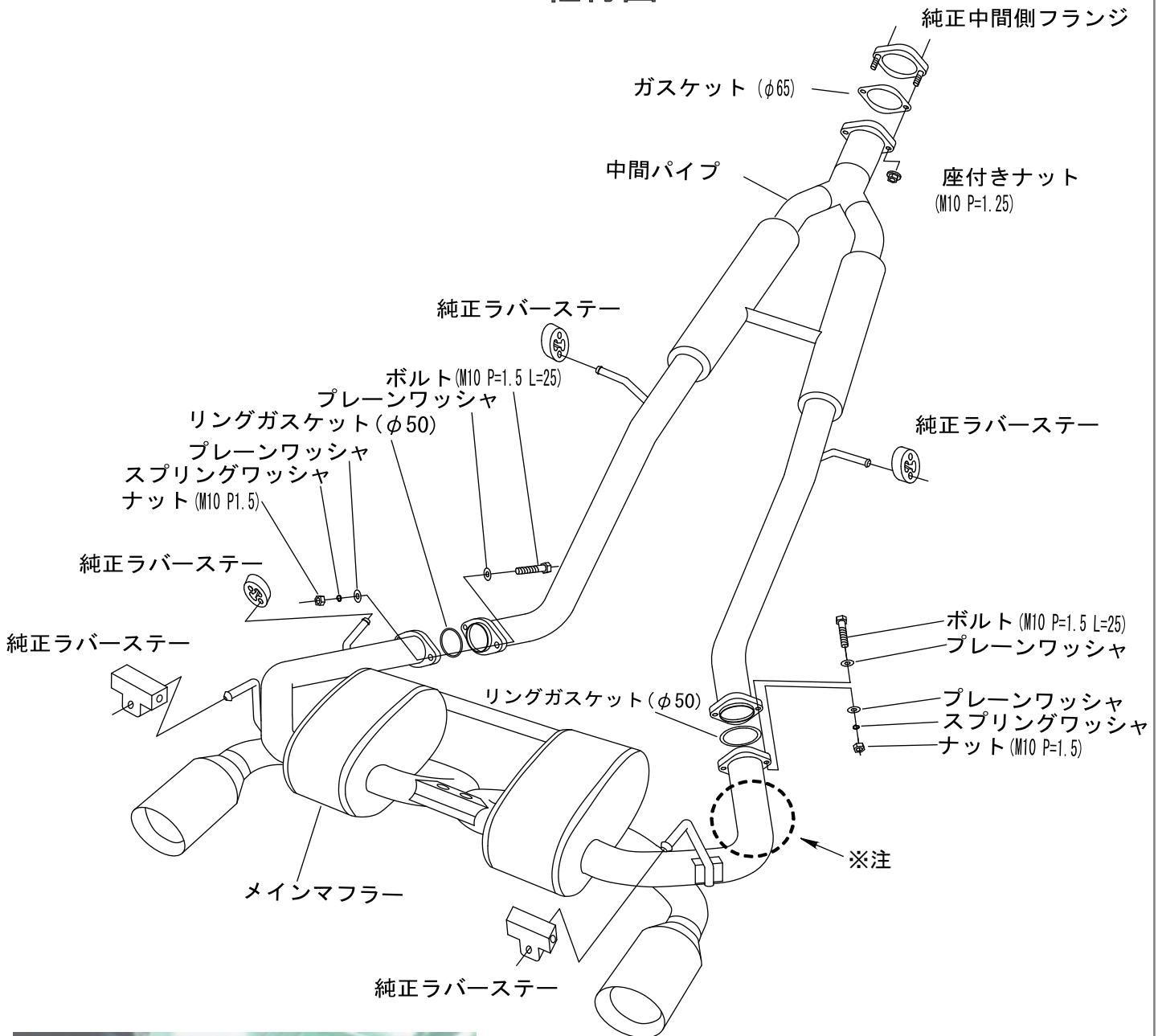
\*注：純正のリアフロアヒートインシュレータと右メインパイプが干渉しますので
