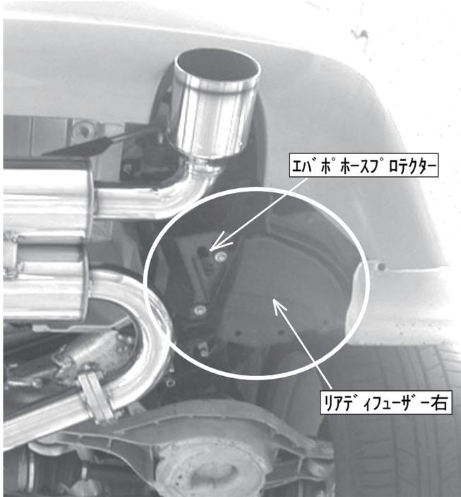
注意：車両によって純正オプションのリアディフューザー・エバホースプロテクターが装着されている車両があります。その場合、マフラーが干渉してしまうため取外してください。
