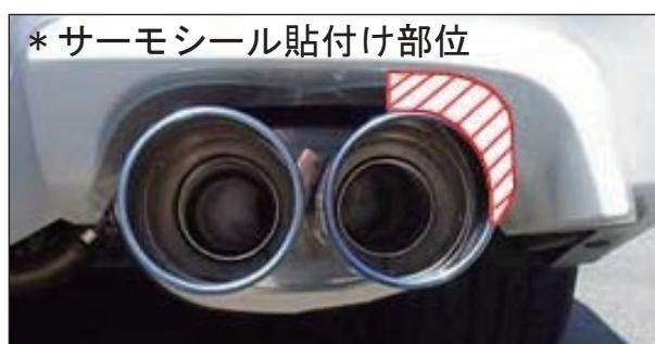
\* 高負荷と強い横Gを伴う走行をした場合、排気熱でテール外側のバンパーが溶ける恐れがあります。付属のサーモシールを○部分（左右とも）に合うようカットし、バンパーに貼付けてください。
