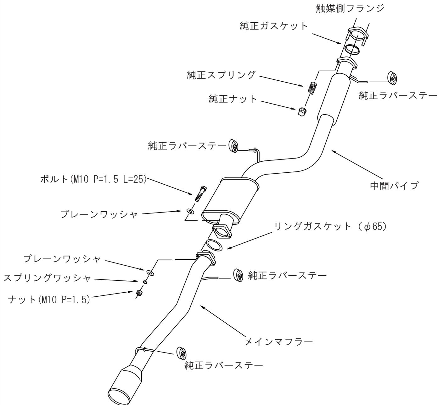
※ 純正マフラー取外しに際して、純正マフラーの切断又はリアメンバーの脱着が必要になります。
