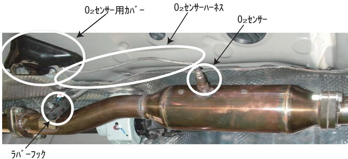
(2) O<sub>2</sub>センサーを触媒に取付けてください。
