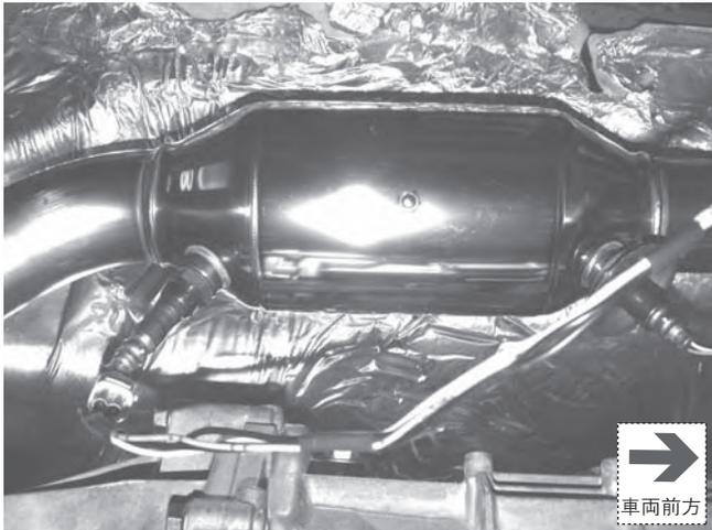
(24) O<sub>2</sub>センサーをフロント・リアを間違えないように取付けてください。 [ 締付けトルク
