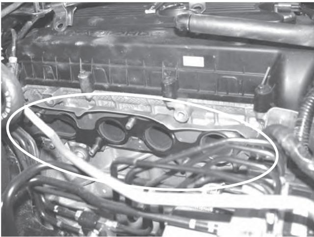
(14) EXマニを固定しているナットを取外し、EXマニを取り外してください。
