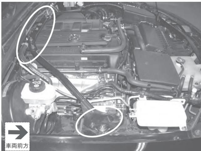
(9) タワーバーを固定しているボルトを取外し、タワーバーを取外してください。
