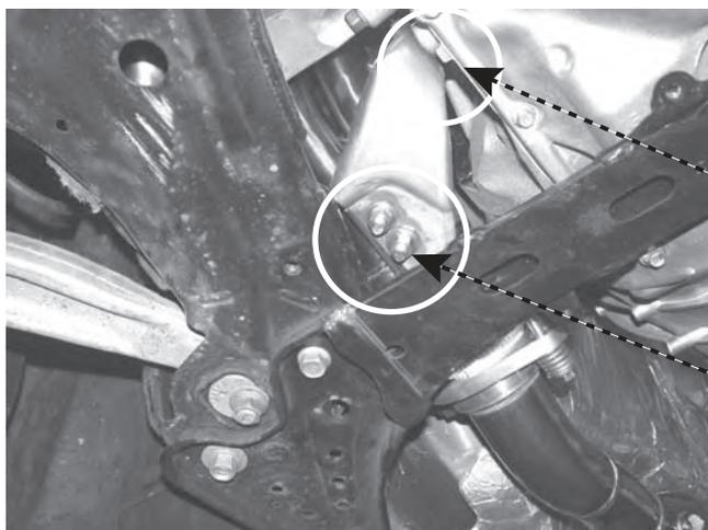
(18) (4) で取外したブラケットとボルトを再使用し、付属のナット、スプリングワッシャ・プレーンワッシャを使用してEXマニを本締付けしてください。
