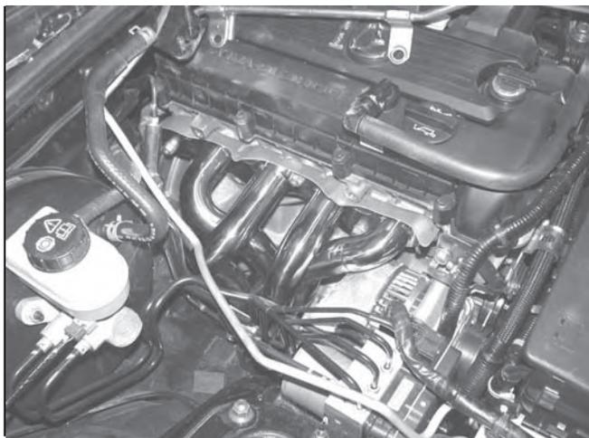
(16) 純正ナットを再使用し、EXマニを本締付けしてください。
