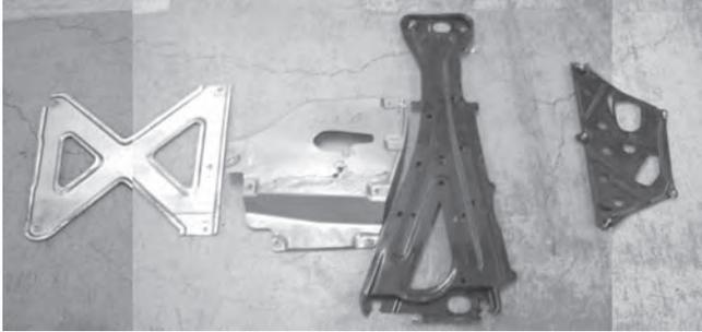
(1) 車両から純正のアンダーカバーを取外してください。
