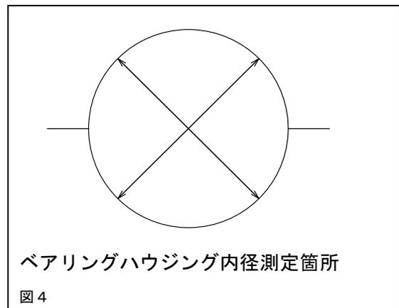
$$(\text{オイルクリアランス}) = (\text{ハウジング内径}) - (\text{ジャーナル外径})$$
