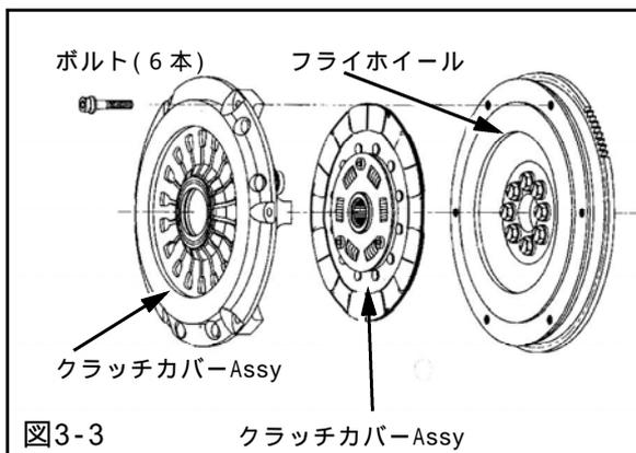
(5) 専用工具(クラッチディスクガイド)を使用し、クラッチカバー-Assyのセンター出しを行なってください。クラッチカバー - 取付け用のボルトを図中の番号順(対角線上)に均等に締込んだ後に、規定トルクで締付けてください。(図3-4)
