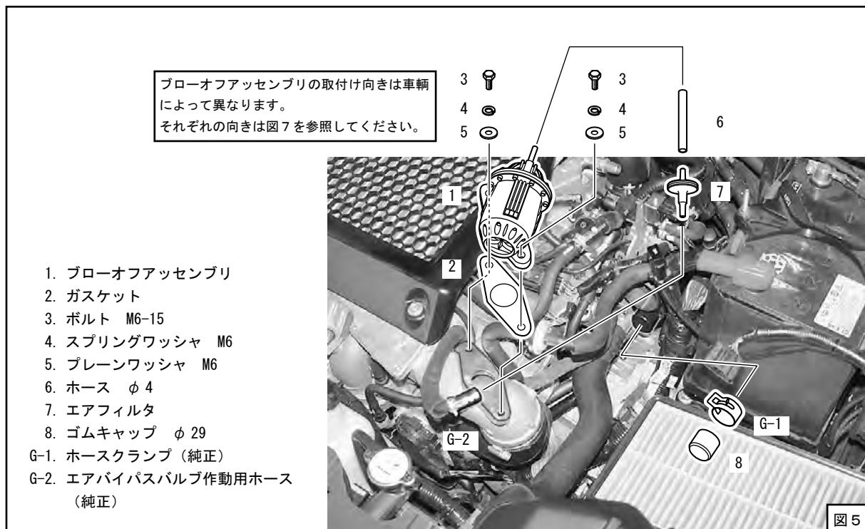
(3) キットパーツを使用してブローオフバルブ作動用の配管を行ってください。
