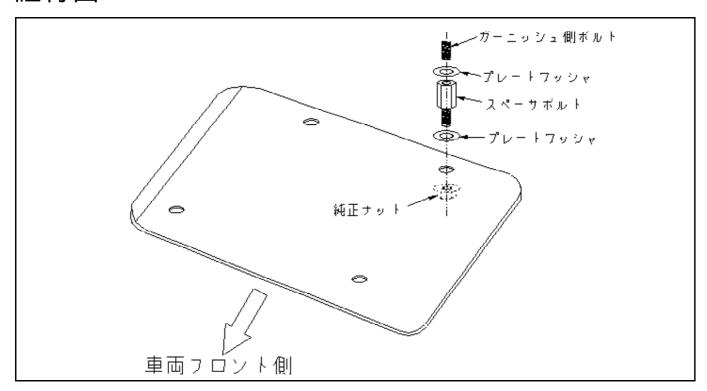
\*車両フロント側から向かって左側のガーニッシュを固定してある4個の ナットを外し、スペーサボルトで固定してください。ダクトカバーは純 正ナットを再使用して取付けてください。
