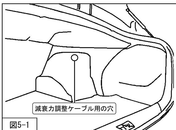
1. トランクサイドトリムに減衰力調整ケーブル用の穴を開けてください。（図5-1）
