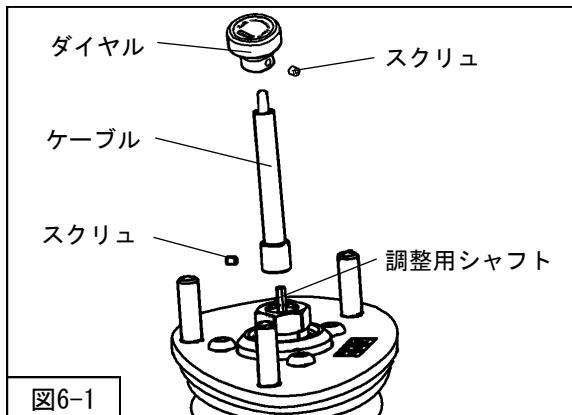
1. 減衰力調整ケーブル（長・同梱品）をリアサスペンションASSY先端の調整用シャフトに取付けてください。（図6-1）
