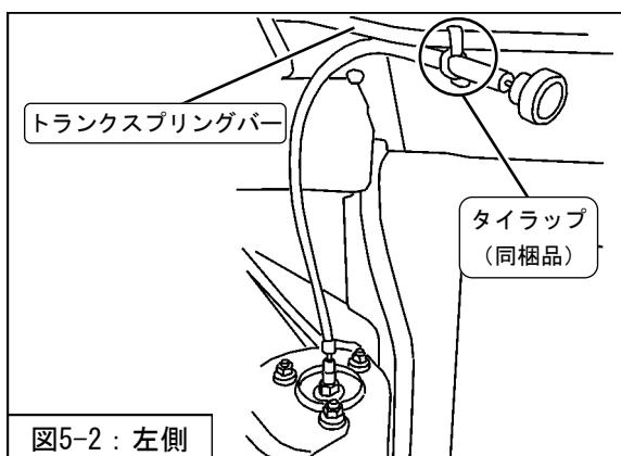
3. タイラップ（同梱品）を使用して、トランクスプリングバーにケーブルを固定してください。（図5-2・図5-3）
