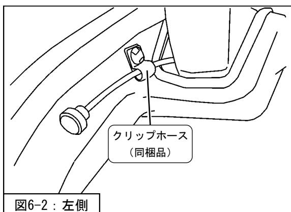
3. クリップホース（同梱品）を使用して、ケーブルをトランク内装に固定してください。（図6-2・図6-3・図6-4）
