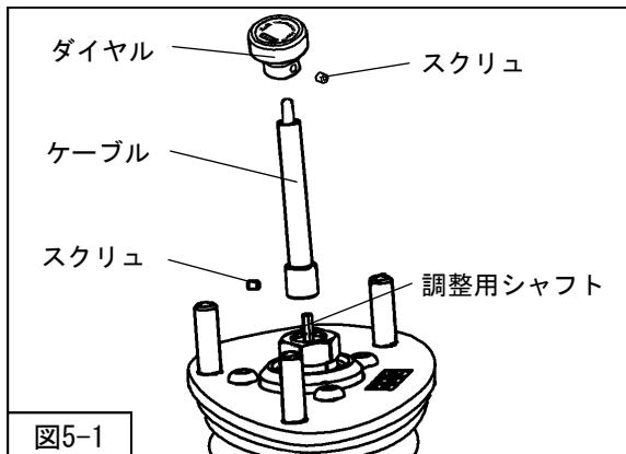
1. 減衰力調整ケーブル（短・同梱品）をリアサスペンションASSY先端の調整用シャフトに取付けてください。（図5-1）
