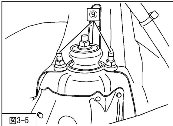
8. ⑨リアショックアブソーバASSYアッパー取付ナットを取外してください。（図3-5）
