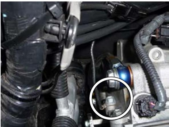
○左バンクインテーク側の VVT-i ソレノイドバルブを回転させ、ソレノイドバルブブラケットで固定する。
