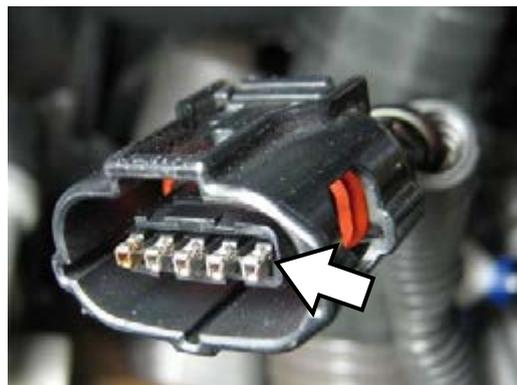
○抜いた端子をおよびダミー栓を6極コネクタに挿入する。
