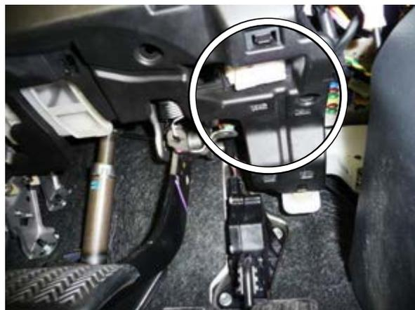
○F-CON iS 通信ケーブルの端子側を、センターコンソール裏の隙間から、運転席側から助手席側に向かって通す。
