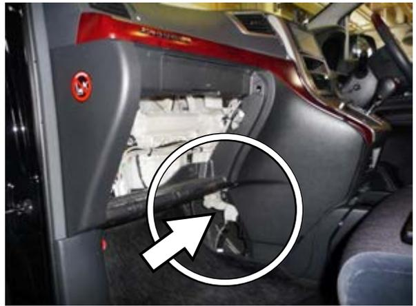
【ここでは F-CON iS をグローブボックス内に設置する例を示します。グローブボックス内に設置できない場合には助手席足元周辺で水がかからない場所等に設置してください。】
