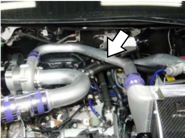
○ホースφ4を図示の長さに切断し、スリーウェイφ4-φ4-φ4、エアフィルターφ4を接続する。
