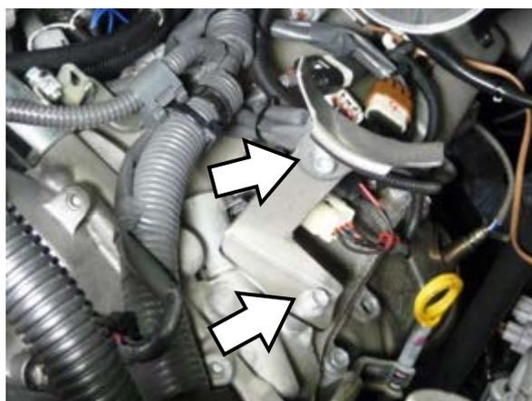
○エアフロアダプターに、純正エアフロセンサーを取付ける。
