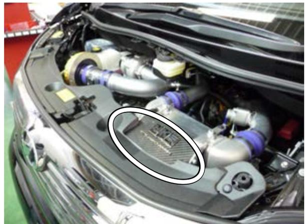
○図示のリブと同じ高さとなるように周囲のリブを切除する。
