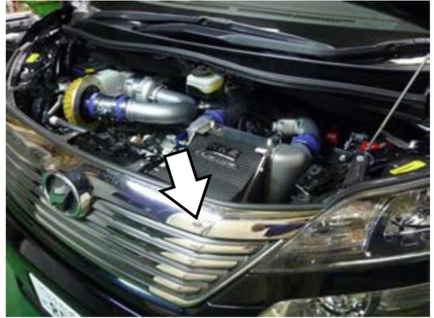
○ラジエータカバーがインタークーラーダクトと干渉する部分を切除する。
