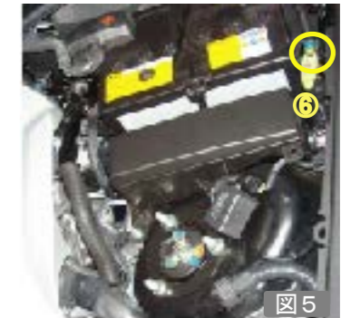
図5の⑥の箇所から、VAC中継ハーネスを車内に引き込みます。この時、図6のようにVAC中継ハーネスのカブラ部分をテープで巻き、保護してください。
