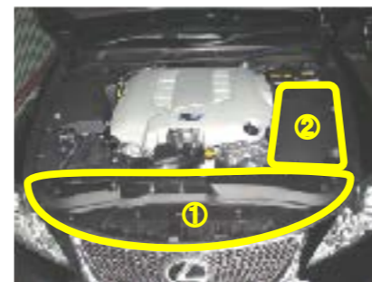
図1の①②の順に、エンジンルームカバーを取外します。
