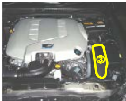
図2の③の箇所の、ECUボックスの上蓋を取外します。
