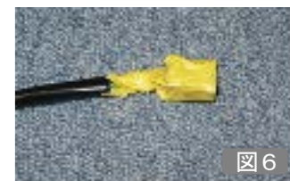
図5の⑥の箇所から、VAC中継ハーネスを車内に引き込みます。この時、図6のようにVAC中継ハーネスのカブラ部分をテープで巻き、保護してください。
