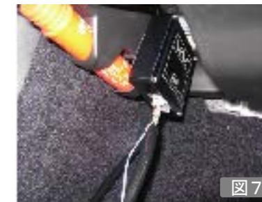
図7のように本体を助手席足元に両面テープを使用し固定します。
