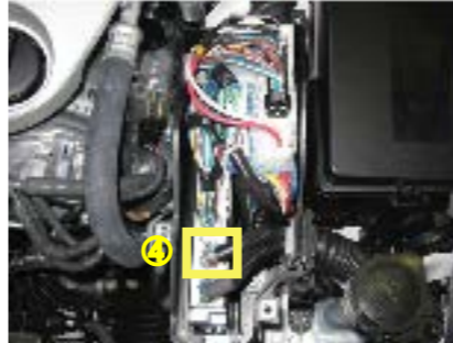
図3のようにECUがあることを確認します。図3の④のカプラをロックを押しながら外します。
