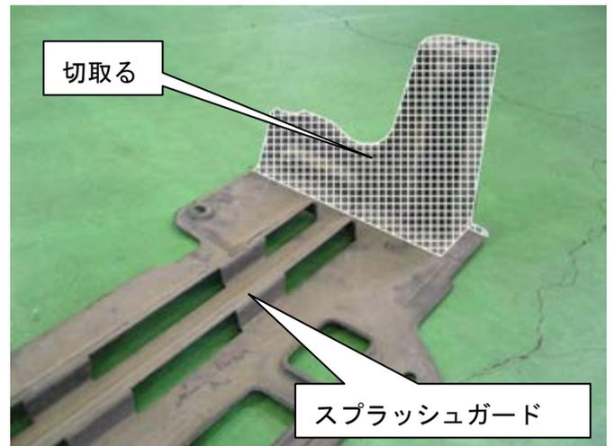
(69) フロントバンパーの図の斜線部分をインタークーラーと干渉しないように切取る。
