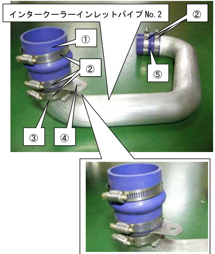
(13) インタークーラーインレットパイプ No. 2Assy を車両に仮付けする。
