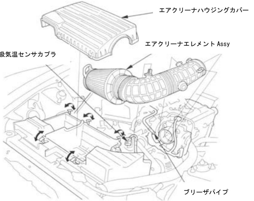
(10) 吸気温度センサーのハーネスクランプを外し、
