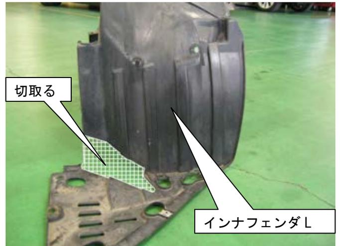
(68) スプラッシュガードの図の斜線部分を左右共にパイプと干渉しないように切取る。
