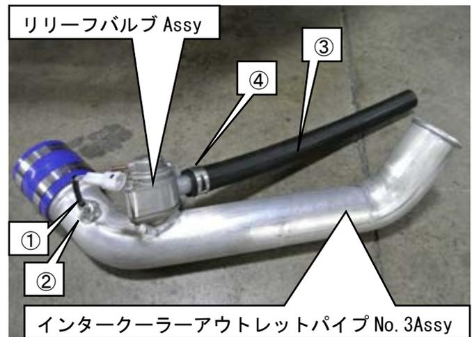
(40) インタークーラーアウトレットパイプ No. 3Assy を車両に仮付けする。
