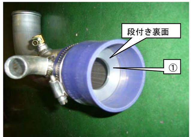
(34) ①(31) でパイプに通したホースバンド #36 を用い、サクションパイプ No. 2 ASSY を車両に仮付けする。
