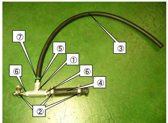
(24) ①純正バキュームホースを取外し、リリーフバルブ作動圧配管を取付ける。
