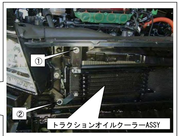
(12) ①・②の純正ボルトを取外し、①ボルトは再使用②ボルトは代わりに
