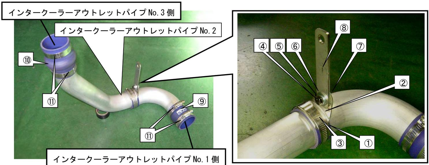
(15) ①ボルトを取外し、インタークーラーアウトレットパイプ No. 2 を仮付けする。
