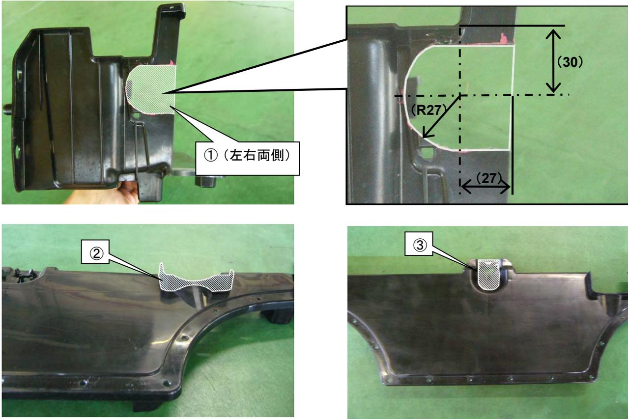
(28) 加工した純正フロントバンパーエアガイド（樹脂部品）を純正ボルト・純正クリップを用い、車両に取付ける。
