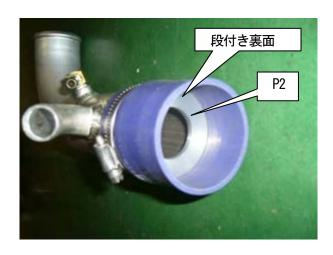
12001-AH008 に取り付ける場合・・・図※部を溶接もしくは耐熱アルミテープでしっかりと固定する。
