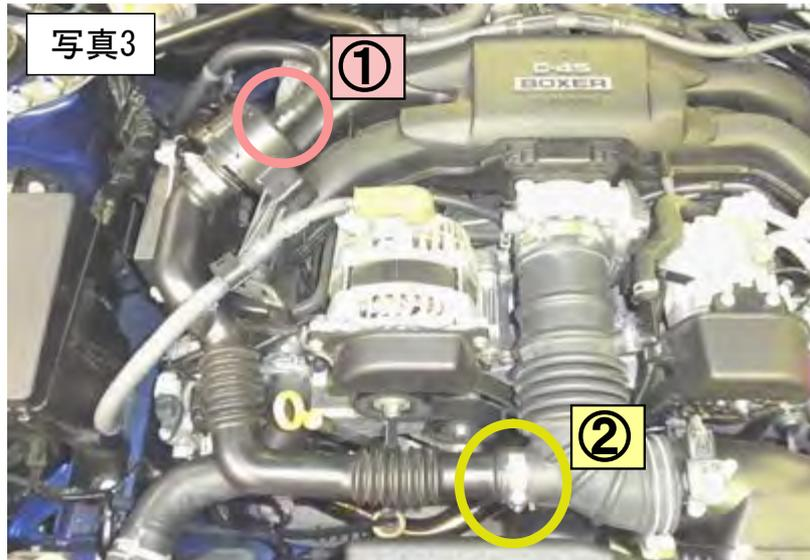
2. (1)写真3-①の場所に付属のプラグ(小)を使用してフタをしたものを、付属のタイラップを使用してプラグの抜け止めをし、車両ブラケットに固定してください。写真4参照
