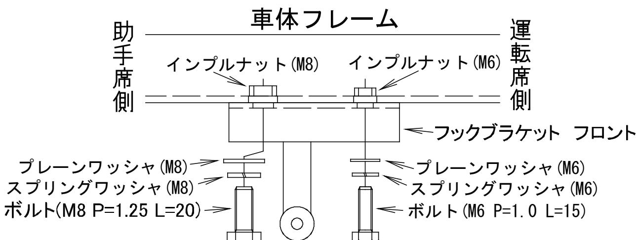
(3) 図1-3および図4を参考にフックブラケット リアの位置を合わせ(フックの抜け止めが車両前側を向く)、付属のボルト(M6)にスプリングワッシャ(M6)、プレーンワッシャ(M6)、ブラケット穴、プレーンワッシャ(M10)2枚の順に通し、ブラケット、プレーンワッシャ(M10)×2、フレーム、インプルナットの順に取り付けて、仮締め付けしてください。図4参照
