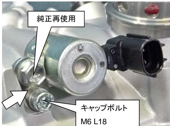
⑥ ソレノイドバルブブラケットで固定する。
