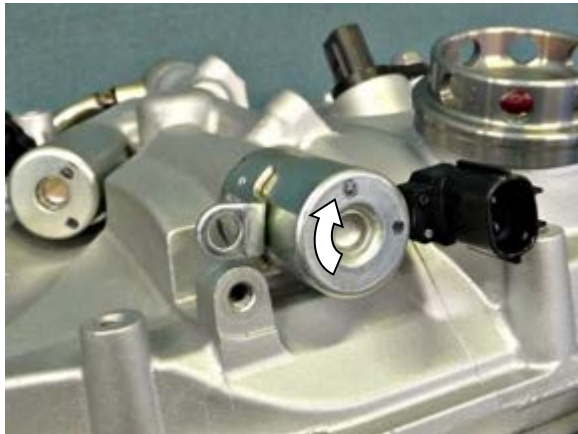
④ 固定ボルトを取外し、約 30° 回転させる
