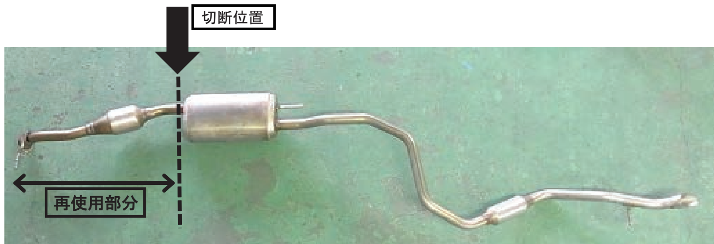
図1. 純正マフラー切断位置
