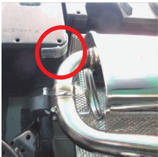
サーモシール貼付け箇所①
