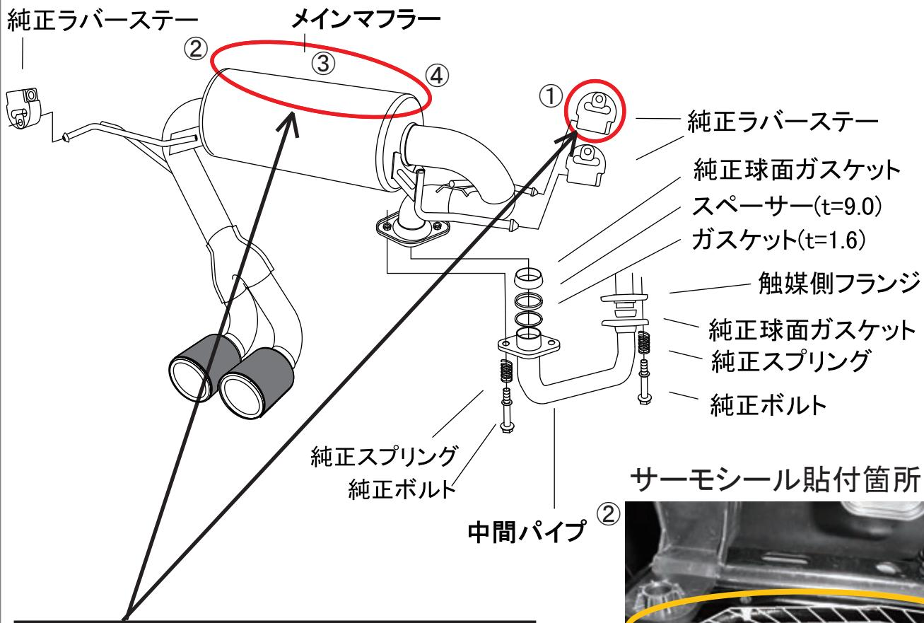
\* 注 : ② の箇所は排気管とのクリアランスが狭くなる場合があります。付属のサーモシールを純正ラバーステー、電気配線に貼付けて遮熱対策を施してください。
