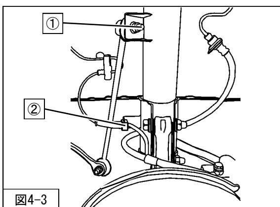
3. ①スタビライザーリンク取付ナット（締付トルク : 44Nm）
