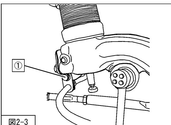
3. ①ブレーキホース取付ボルト（締付トルク : 22N·m）
