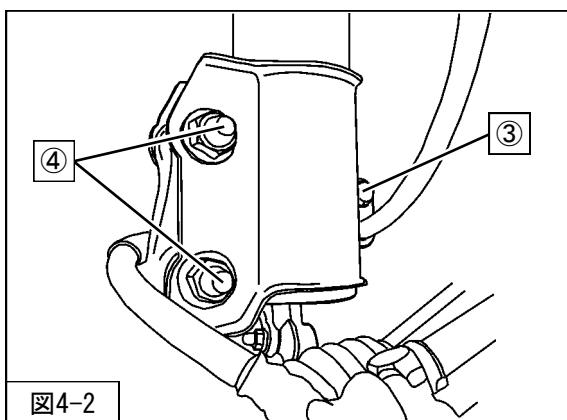
2. ③ブレーキホース取付ボルト（締付トルク : 22N·m）
