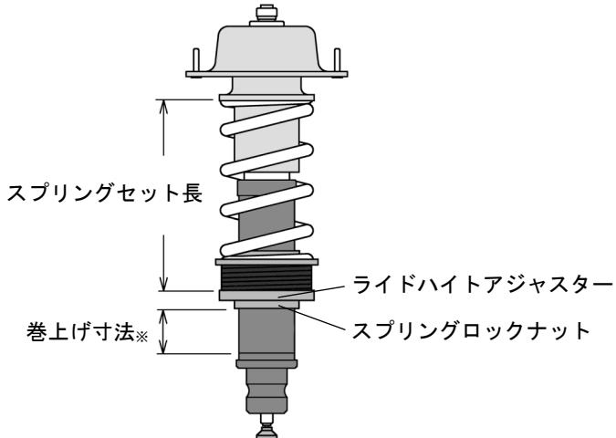
※巻き上げ寸法は、スプリングロックナット下端からシリンダーネジ部下端までの長さです。
