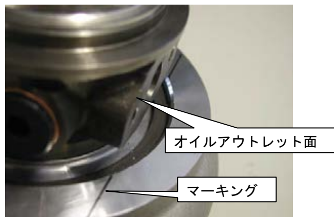
図②. オイルアウトレット位置マーキング
