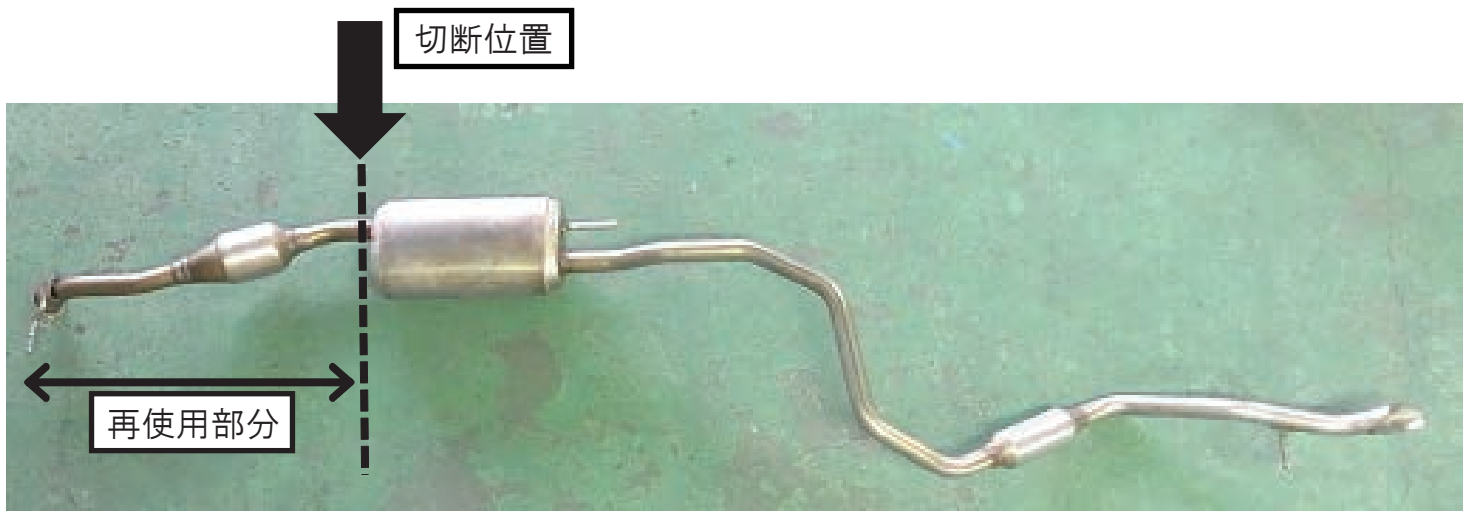
図11. 純正マフラー切断位置
