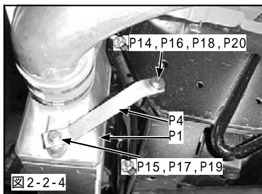
(6) インタークーラインレットパイプ、インタークーラアウトレットパイプ 1, 2を取付けてください。
