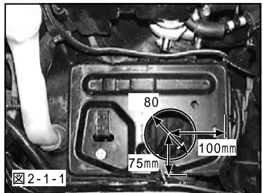
(2)インレットパイプ取付けのため、図の位置にある穴を約 70に拡大してください。(図2-1-2)
