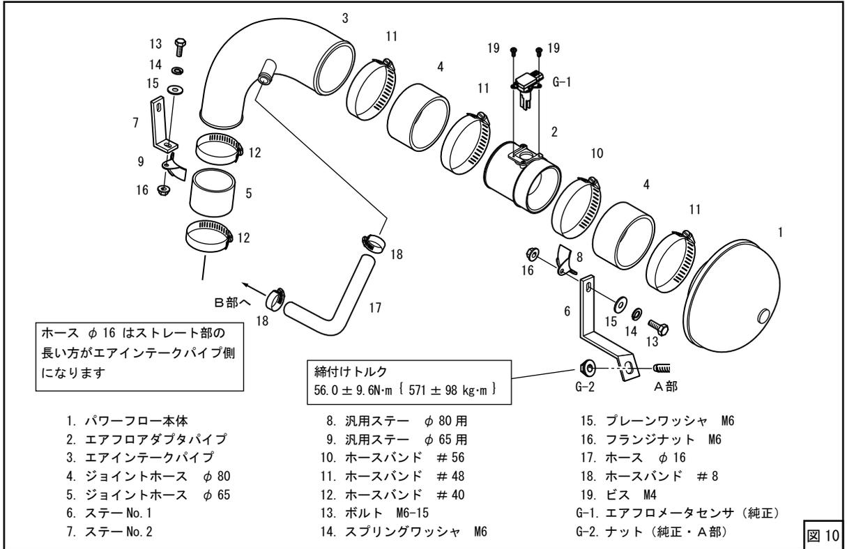
(4) パワーフロー本体がボディなどと干渉しないように位置を決めてください。位置が決まったら、ホースバンド・ボルトを固定してください。この時ホースバンド・ボルトを締めすぎないようにしてください。(図14)
