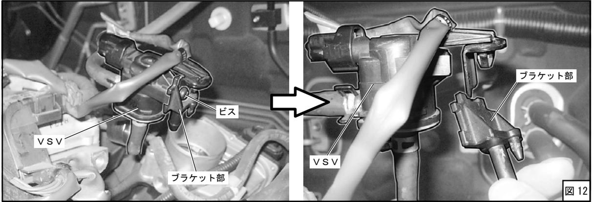
(6) VSVを純正ビスを再使用してステーNo.2を挟み込むように取付けてください。その際VSVに接続されているホースがつぶれないようにしてください。(図13)
