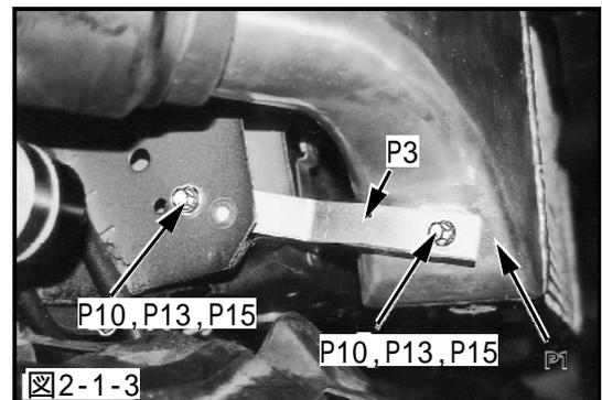
(6) インタークーラステー 1, インタークーラステー 2を本締めしてください。(図2-1-2, 図2-1-3, 図2-1-4)
