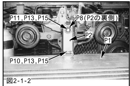
(4) ボルトM8 L=15, ワッシャM8用, スプリングワッシャM8用を使用して、インタークーラステー 2を車両に取付けてください。
