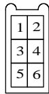
燃料 GCC・点火 GCC コネクタを端子挿入側から見た図
