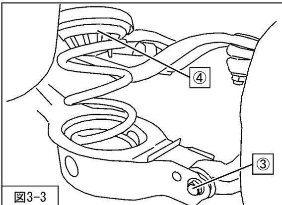
5. ③ロアアーム取付ボルト・ナットを取外し、スプリングを車両から取外してください。(図3-3)
