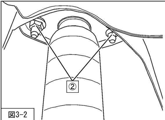
3. ②リアショックアブソーバASSYアッパー取付ナットを取外してください。(図3-2)
