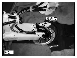
(5)ポンプAssyを分解して純正ポンプを取外してください。 *<図2-5、2-6>*ケース、配線、フィルター等は再使用します。
