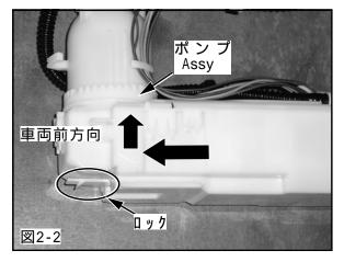
(4)ポンプASSYをフューエルタンクから取出してください。*<図2-3>* この時に、配管や配線を傷つけないようにしてください。 ポンプASSY奥側の燃料ラインを外して下さい。*<図2-4>*
