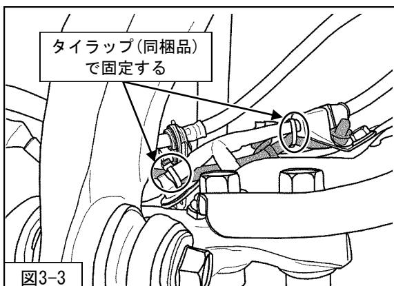
外したADSコネクターは防水を施し、タイラップで車体へ固定してください。（図3-3）
