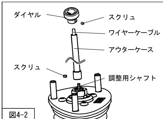
2. 調整用シャフト側面の平面部にスクリュの位置を合わせ、
