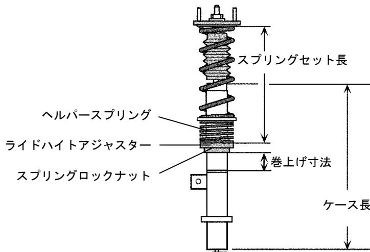
※巻き上げ寸法は、スプリングロックナット下端からシリンダーネジ部下端までの長さです。
