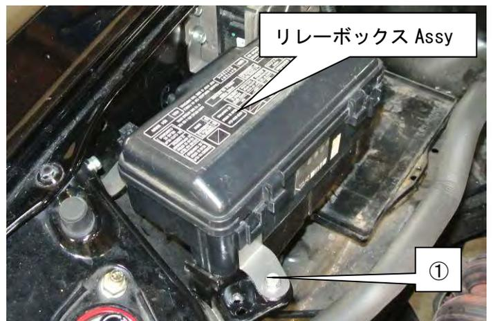
(24) エアコンパイプ (太) のクランプを取外す。
