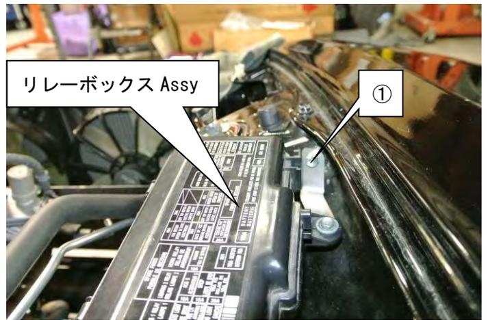
(22) ①純正 EPS コントロールユニット固定ボルトを取り外し、
