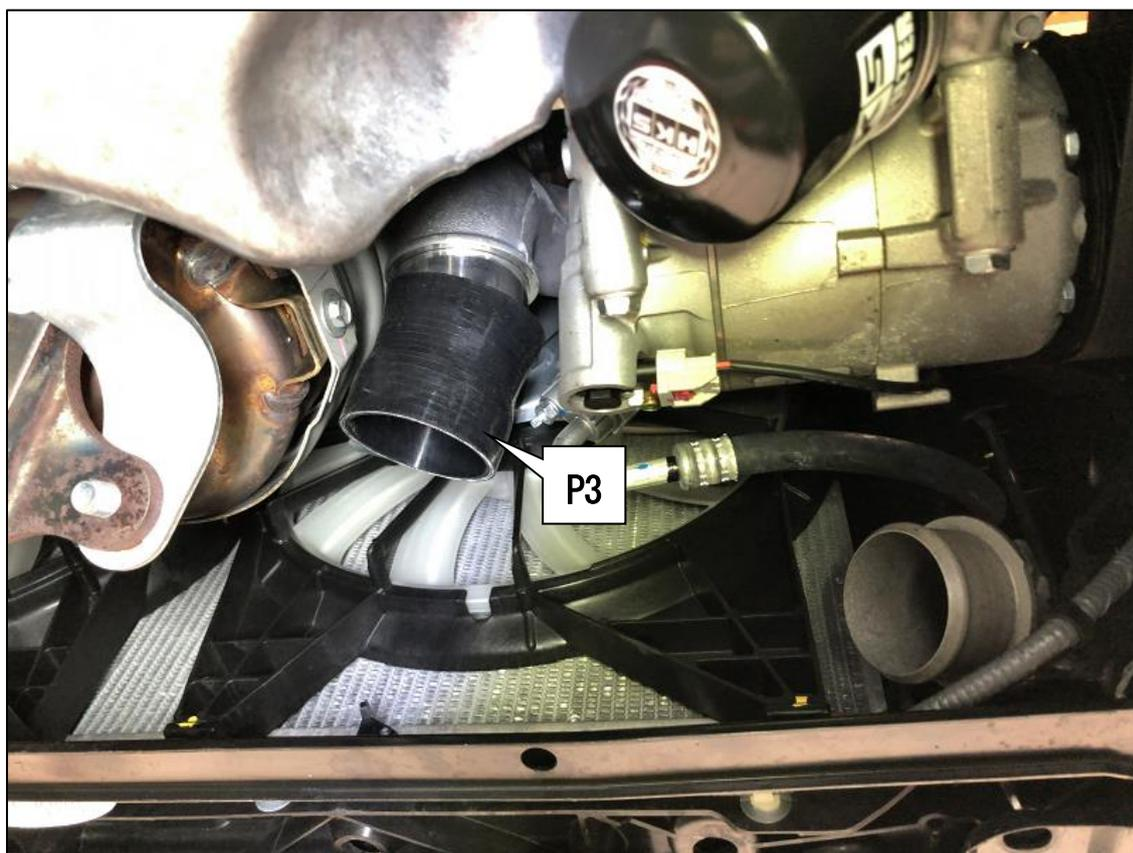
(3) インタークーラーインレットパイプをターボチャージャーとインタークーラーに取付ける。
