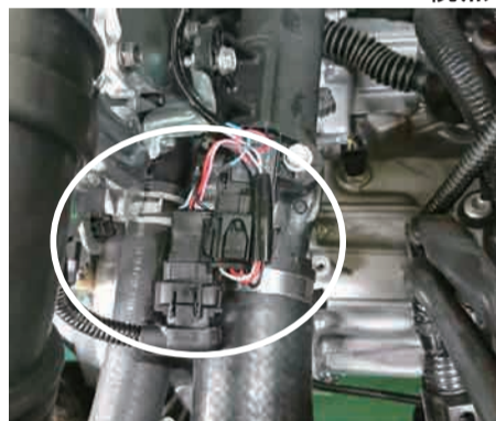
圧力センサ位置（チャンネル 1 側） Power Editor ハーネスを割込み接続
